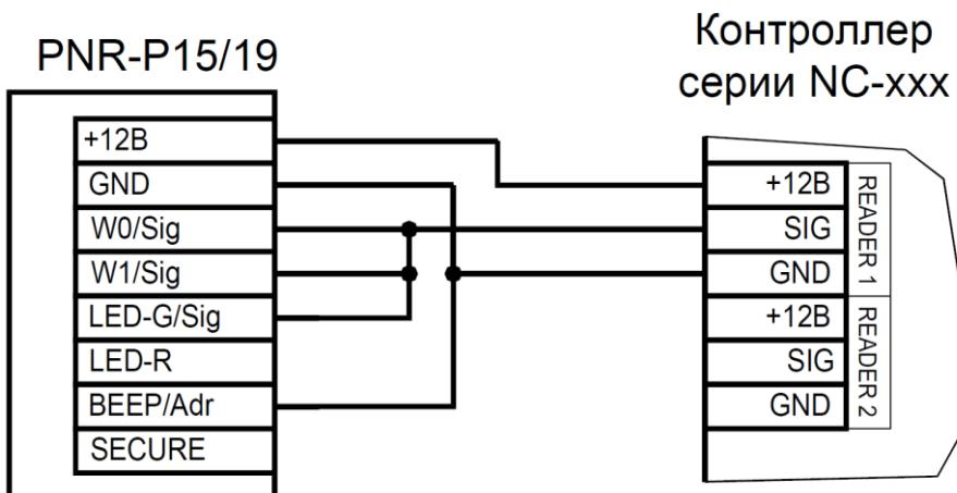
Рисунок 8. Подключение считывателя в режиме Parsec, адрес 0 (наружный)
