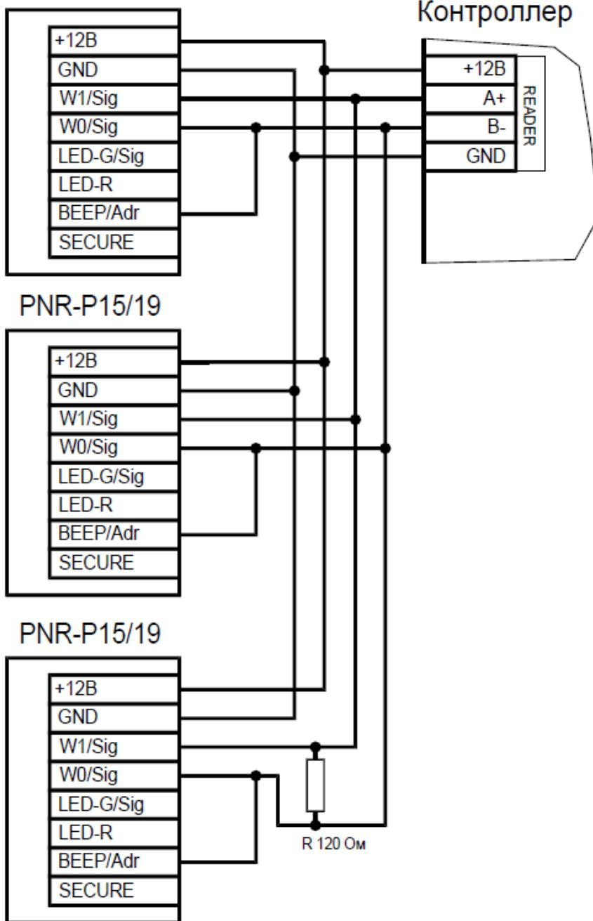
Рисунок 10. Подключение считывателя в режиме OSDP
