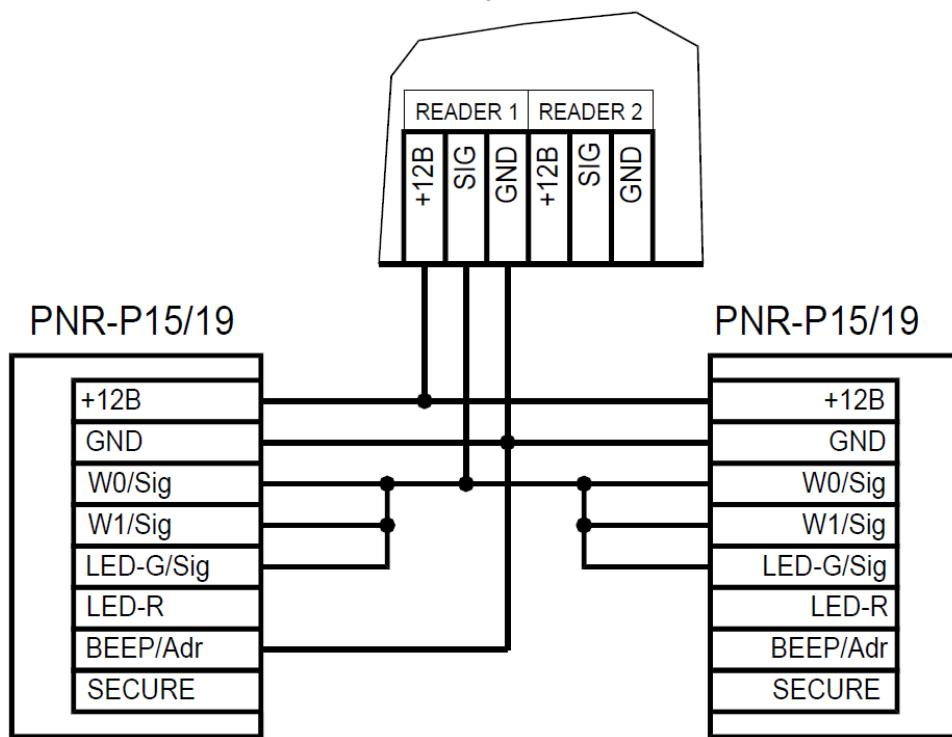
Рисунок 9. Подключение двух считывателей в режиме Parsec одним кабелем
