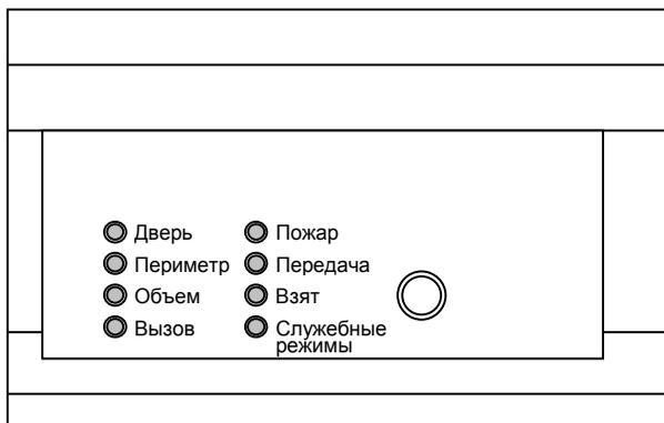
Рис. 2. Внешний вид выносного блока индикации
