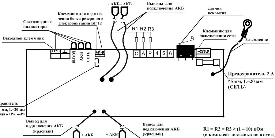
Рисунок 1 – Плата источника
