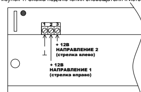
Рисунок 1. Схема подключения оповещателя к источнику питания*
