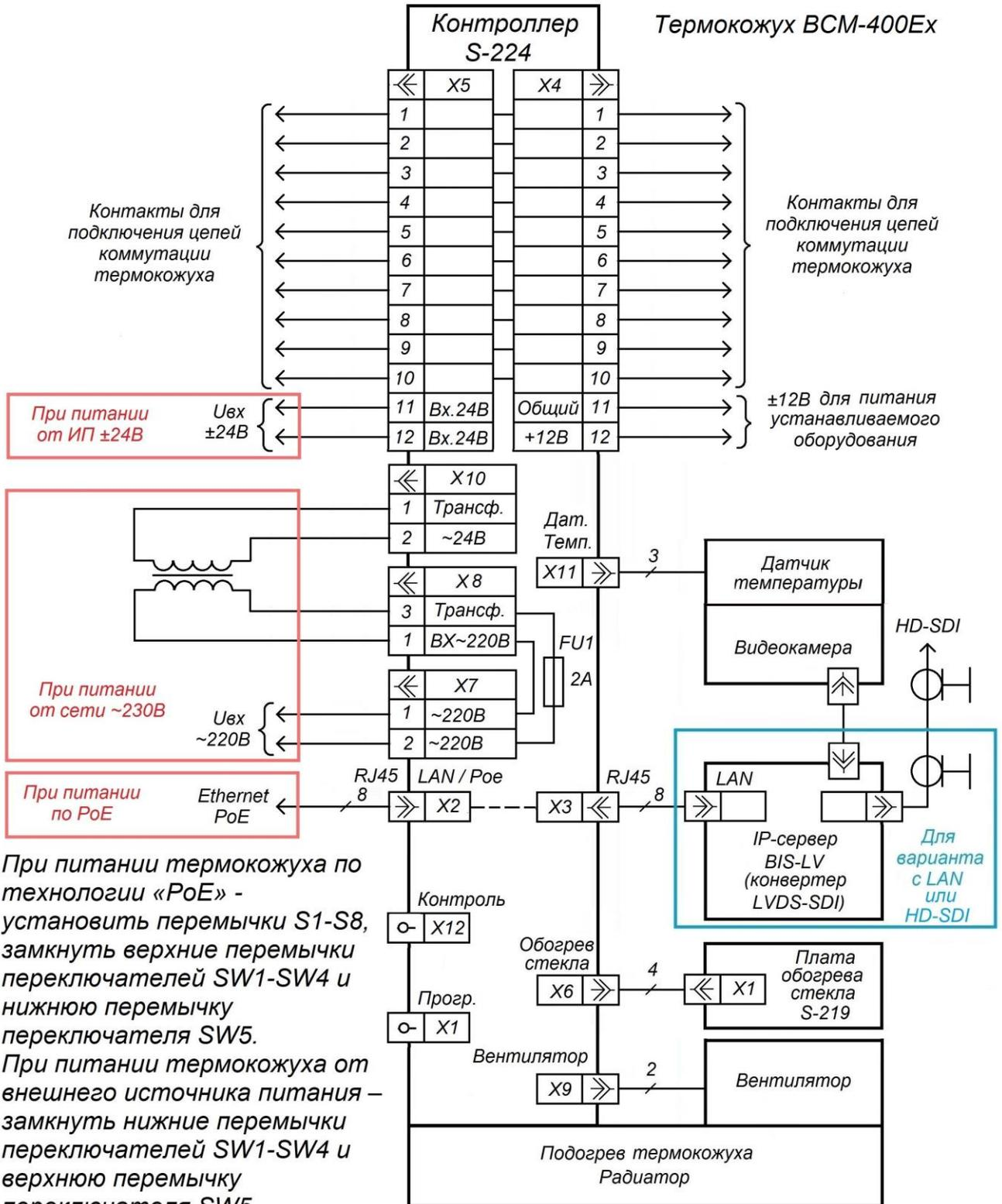
Рис.5.1.1 Общая схема подключения термокожуха BSM-400Ex
