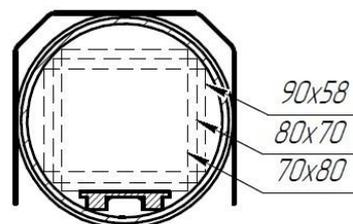
Рис. А.1 Габаритные и установочные размеры термокожуха
