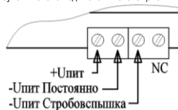
Рисунок 1. Схема подключения оповещателя к источнику питания
