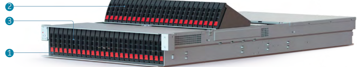
Установленные 48x2'5 диска в дисковую корзину
