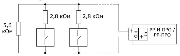
Подключение нормально замкнутых пожарных извещателей с выходом типа "сухой контакт":
