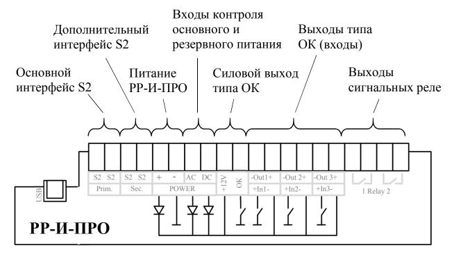
Примечание: на рисунке показана внутренняя структура в случае конфигурирования выходов 1, 2, 3 в качестве **выходов**
