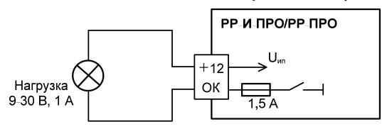
Схема подключения силовых выходов типа "Открытый коллектор" с внешним источником питания постоянного или переменного тока.
