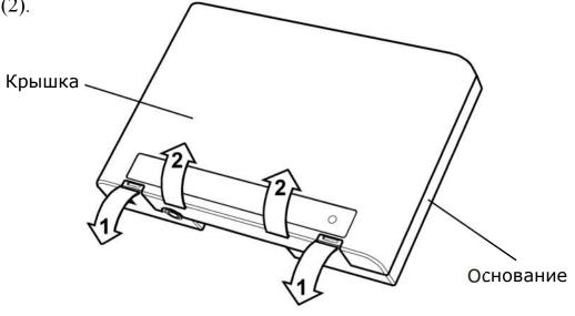
Для того, чтобы закрыть корпус, необходимо сначала зацепить крышку за основание сверху, а потом полностью закрыть прибор.
