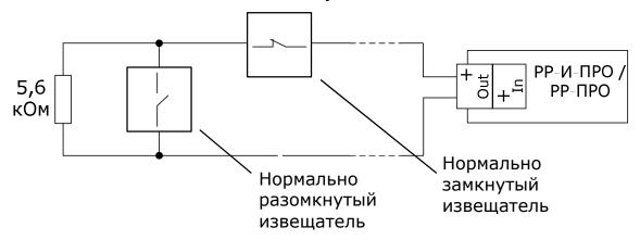
Схема подключения **нормально разомкнутых пожарных** извещателей с выходом типа "сухой контакт":
