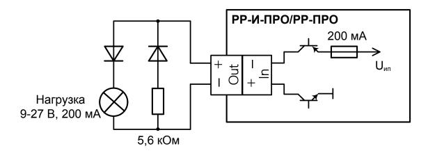
Схема подключения силовых выходов типа "Открытый коллектор".
