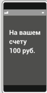
Запросить баланс можно, когда сигнализатор снят с охраны, нажав кнопку **\*** на брелоке.
