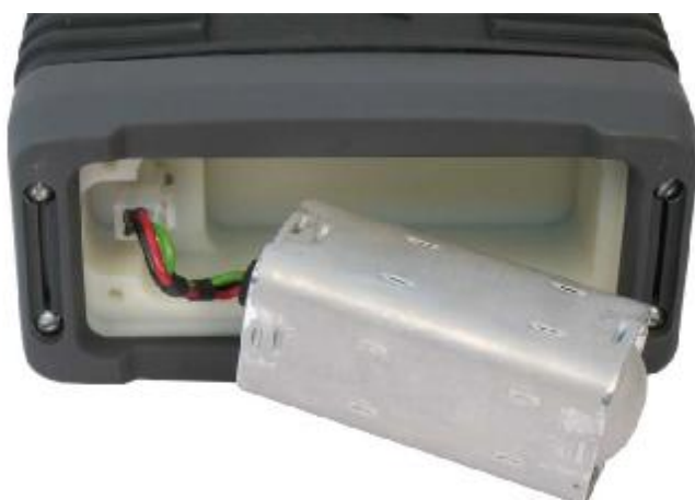
Рис. 48 – 50 Замена аккумуляторной батареи (I)
