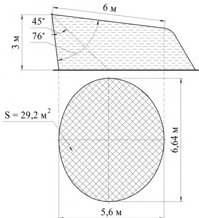
Рисунок 18 - Область орошения на горизонтальной плоскости
