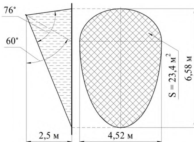
Рисунок 19 - Область орошения на вертикальной плоскости
