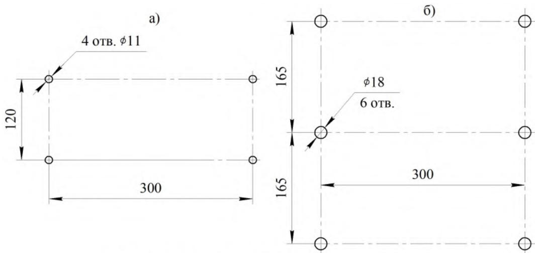
Координаты отверстий: а) - для крепления на полу;
