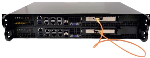
Первое устройство в несекретном сегменте сети забирает файлы с FTP-сервера и передаёт их второму устройству по одностороннему каналу в секретном сегменте. Второе устройство, после получения файлов, проверяет их целостность и в случае успешной передачи, загружает файлы на FTP-сервер, который расположен в секретном сегменте сети.
