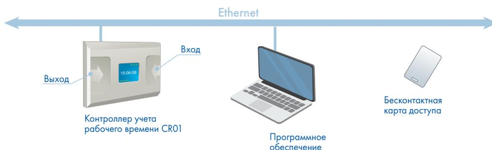
При поднесении карт доступа к встроенным считывателям в энергонезависимой памяти контроллера запоминаются события «Вход» или «Выход». При наличии связи с сервером систем PERCo события передаются в базу данных и далее, наравне с событиями от других контроллеров системы, используются для построения требуемых отчетов.
