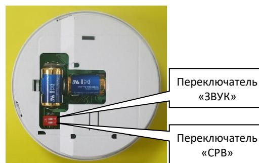
Двойным нажатием на тестовую кнопку извещателя инициируйте передачу посылки на прибор. Прибор, получив эту посылку, обрабатывает её и выдаёт результат:
