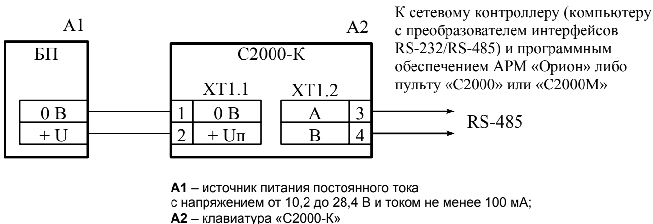
Рисунок 1 Схема подключения клавиатуры «С2000-К» при эксплуатации
